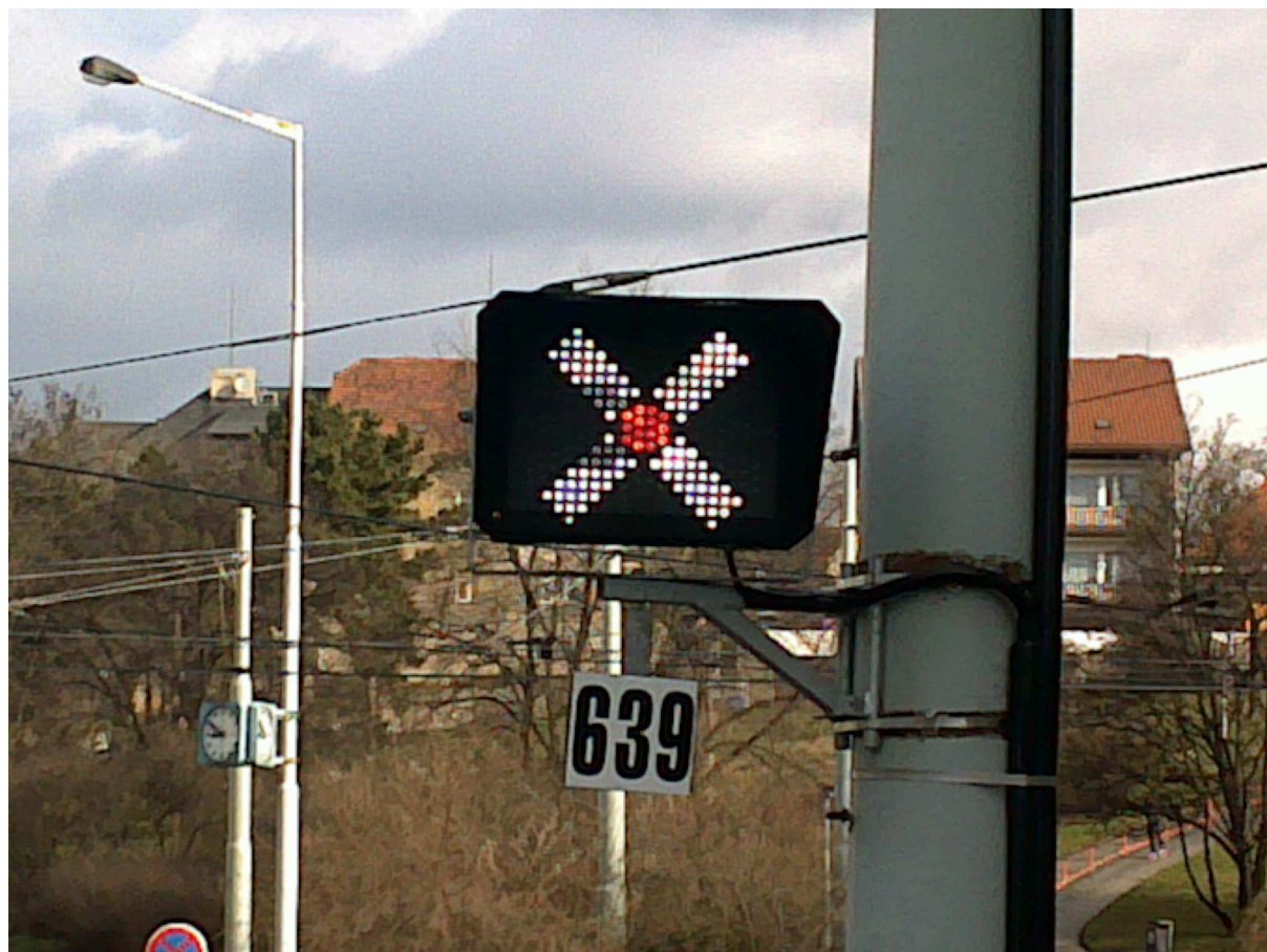
„Pracovní trolejový kontakt mimo provoz“, resp. „Rádiové ovládání výhybky mimo provoz“ se signalizací „Neurčité vlakové cesty“ - výhybka neuzamčena
